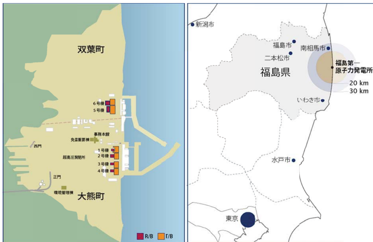
図1.1.1-1 福島第一原発の位置図（右）と主要施設の配置図（左）。（左）図のR/Bは原子炉建屋、T/Bはタービン建屋。
